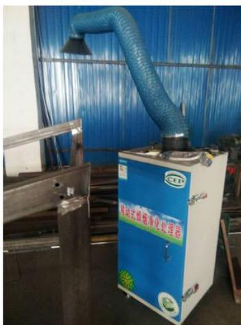
图 3-1 移动式焊烟净化器图片
