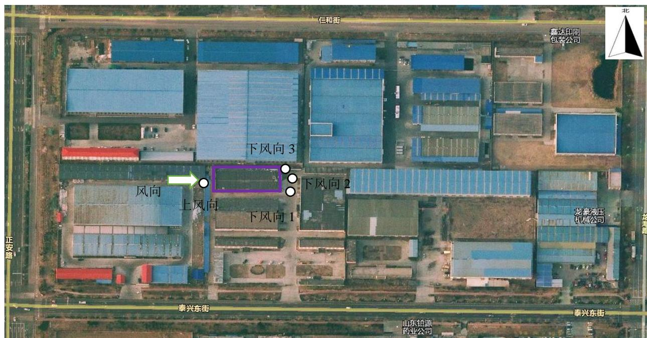
图 6-1 无组织废气监测布点图
